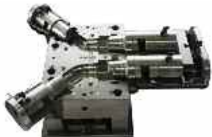
Extrusion-soufflage de conduits à formes complexes en polyalpaoléfinés, pour l'aéronautique
