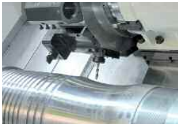
Perçage pilote avec foret classique sur surfaces concaves et convexes
