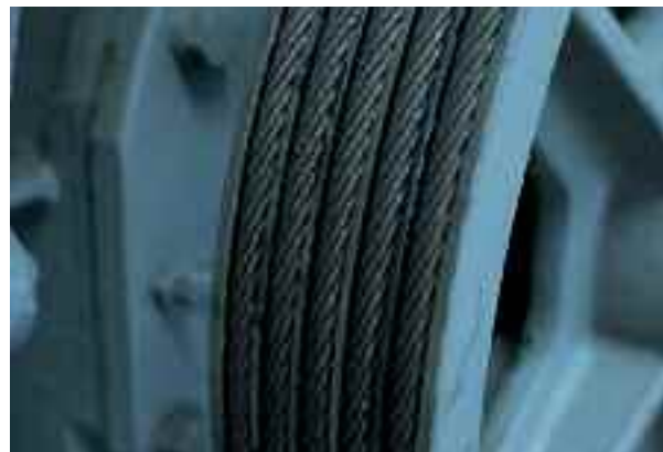
Câbles de traction, ascenseurs, monte-charge, sas, écluses
